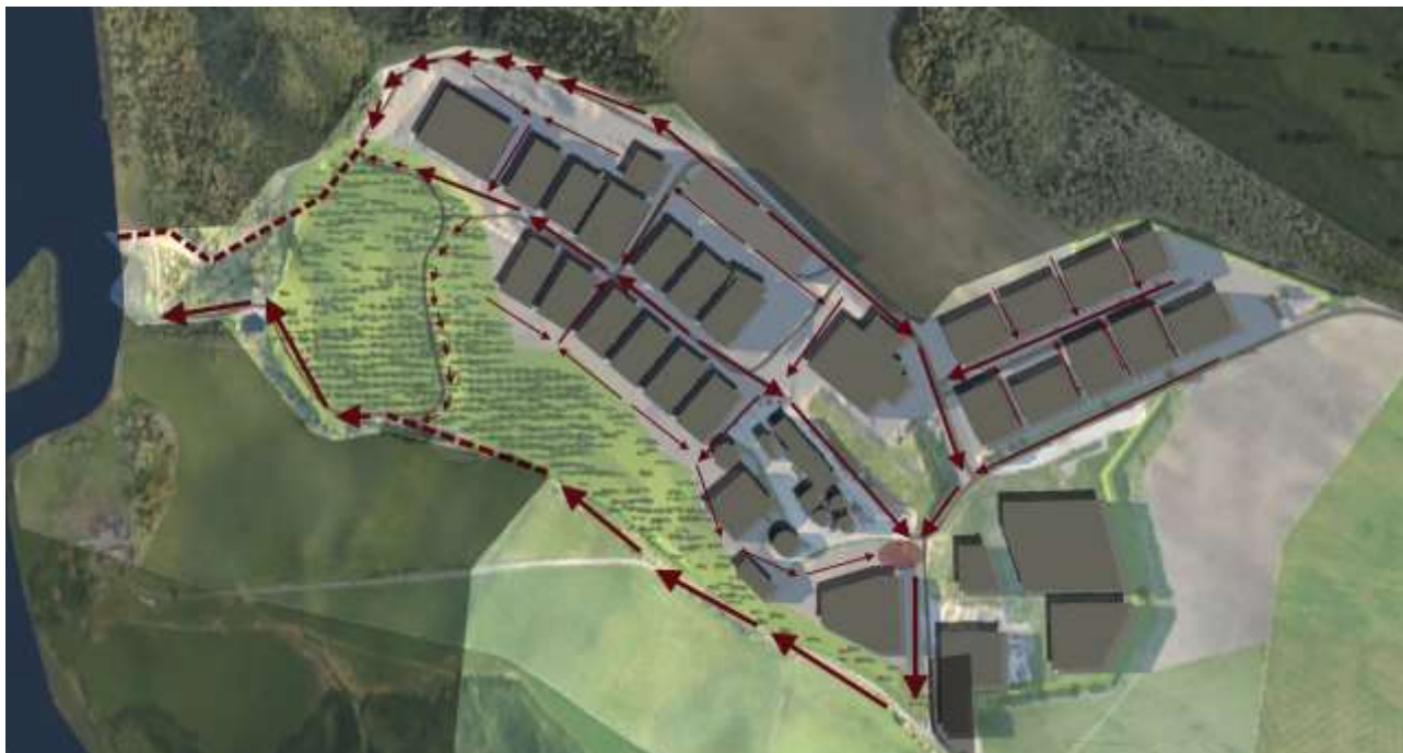
Figur 13: Planforslagets overvannshåndtering. Brede piler er store vannveier, smale piler er små vannveier
