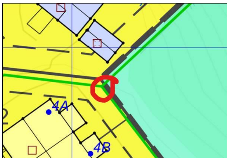
Figur 2. Typisk avvik mellom plangrense (sort stiplet strek) og klarlagt eiendomsgrense (grønn strek) mellom reguleringsplan for Øvre Fjuk og Nordlitunet.
